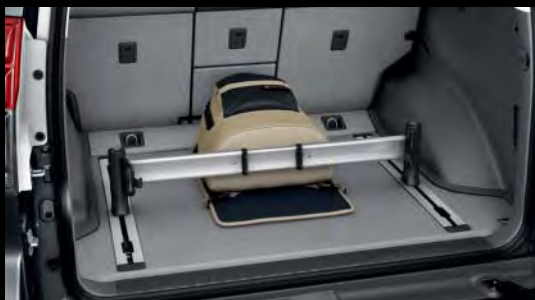
CARGO-MANAGER, ALUMINIUM-TELESKOPSTANGE MIT GURT ZUR FIXIERUNG VON GEPÄCK
